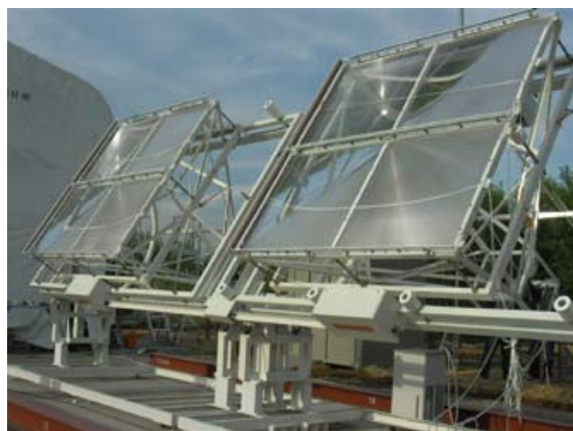
◎図2 千歳市に建設された4m 2 レーザー。一基あたり、1kWのレーザー出力を目指す。
