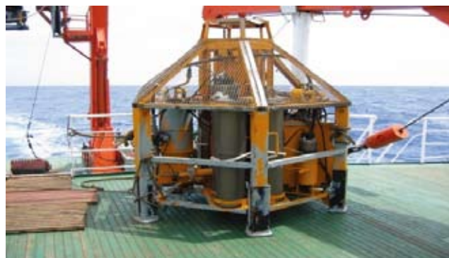
◎図6 浅層ボーリングマシン（掘削深度70cm）
