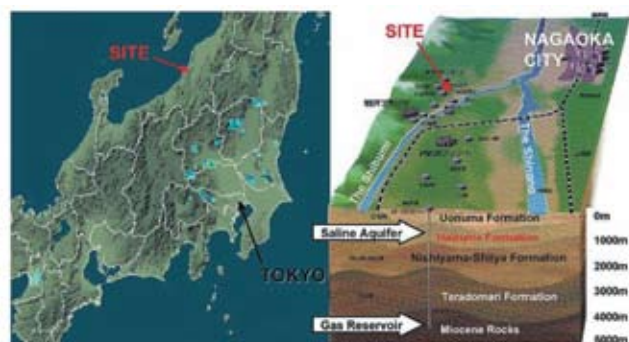
◎図1 長岡CO 2 圧入実証試験サイトおよび地質構造の概念図。
