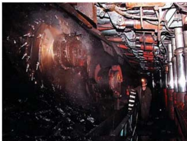
◎図2 海底の炭層に向けて延長し採掘する（中国海洋事業）
