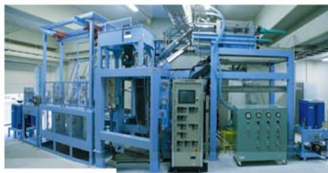
◎図3 二段式亜臨界水酸化用パイロットプラント
