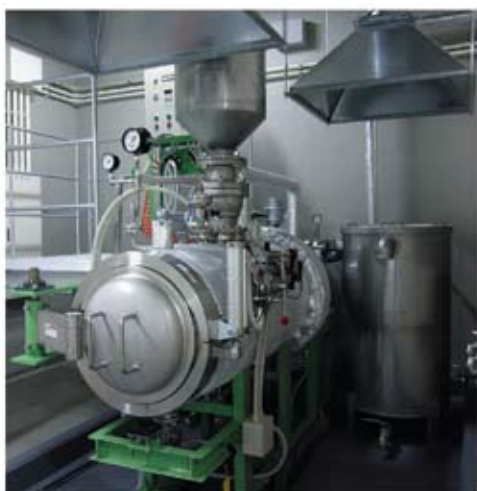
◎図10 水熱粉末燃料化装置（内容積：0.3m 3 ）
