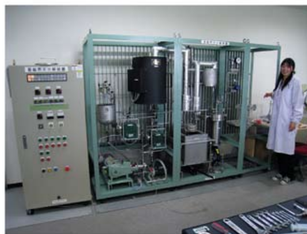
◎図9 流通式亜臨界水加水分解装置
