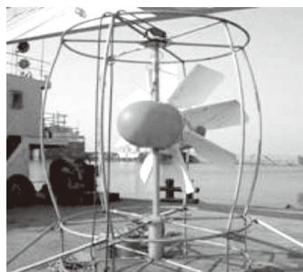
◎図18 低流速海流発電装置(2kW)
