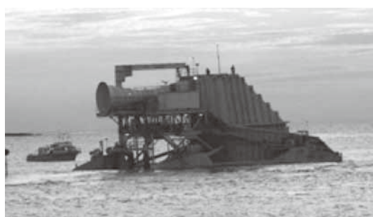
◎図3 振動水柱装置（オーストラリア、500kW）
