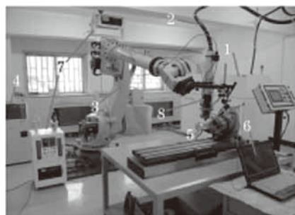
◎図1 マシンビジョン機能を持つレーザ再製ロボットシステム
