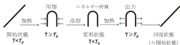
◎図1 形状記憶ポリマー材料の熱-機械変形プロセス
