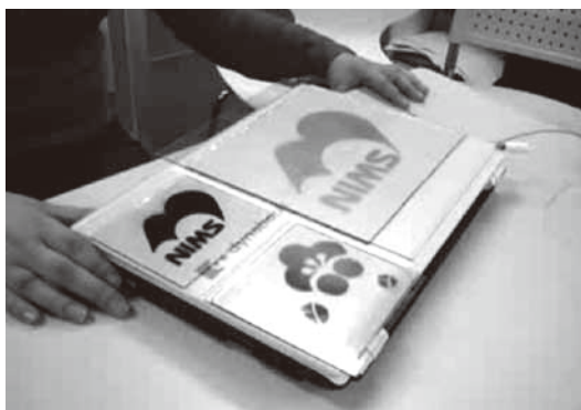
◎図4 有機／金属ハイブリッドポリマーを用いたエレクトロクロミック型固体表示デバイス
