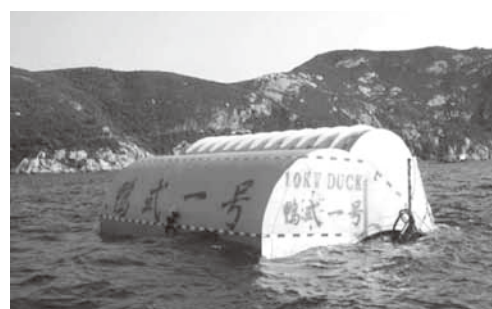
◎図14 中国10kW浮体式ソルターカム式装置
