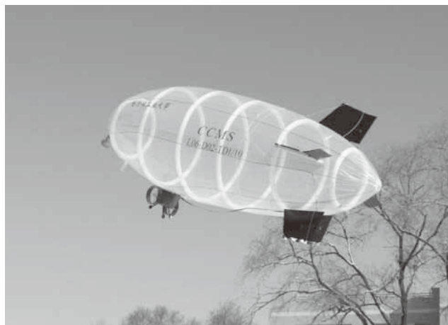
◎図1 ハルビン工業大学の採用した超軽量気嚢・ガス充填フレーム飛行船試作機の低圧飛行試験
