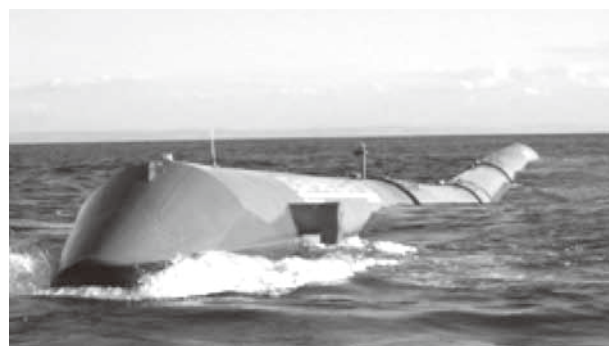
◎図7 海蛇式波力発電システム（英国、750kW）
