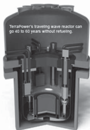
第8-16図 テラパワー社のTWR （燃料を交換しないで40～50年の運転が可能）
