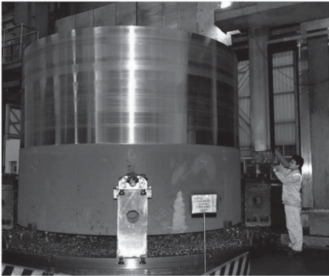
第8-10図 CAP1400向け蒸気発生器シェル鍛造品
