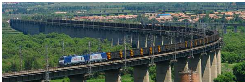
写真 1:「大秦線」を駆ける世界最長の貨物列車（編成全長 2.6km、最大編成 216 両）
