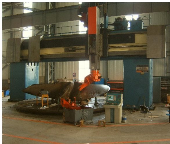
図 CKX5680 7軸5連動重型Mill/Turn 複合加工センターの使用現場
