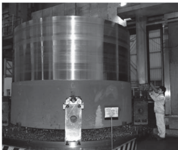
第8-10図 CAP1400向け蒸気発生器シェル鍛造品
