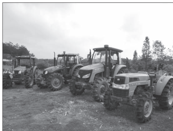
【写真1】2012年安徽省の合作社が保有しているトラクター。左側の2台は共に定格出力59kW。右から2台目に関しては、定格出力73.5kW。右端のトラクターは、定格出力40.4kW。全て中国企業の製品であり、中国農業機械工業年鑑において大中型に分類される。
