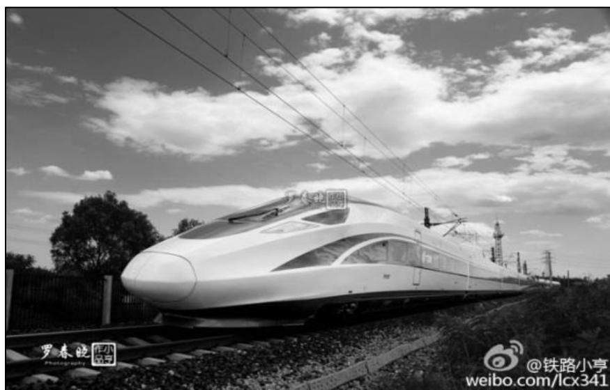
図11 中国標準動車組(4M4T、最高営業速度350km/h、最大軸重17t。写真提供:羅春曉)
