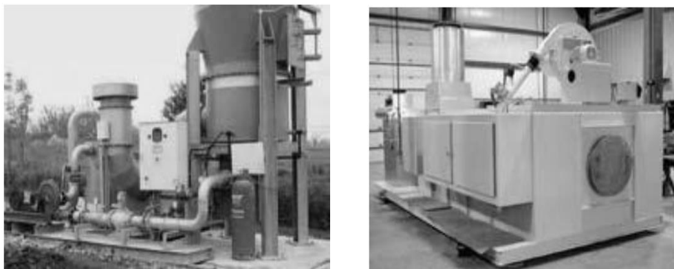
図表144 直接燃焼法式脱臭装置(左)と触媒燃焼式脱臭装置(右)
