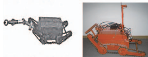
図2-3-12 炭鉱レスキューロボット (a) 先頭ロボット、(b) 支援ロボット 40
