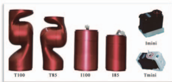
(b) 博文ロボット会社の一体化の関節モジュール (c)
