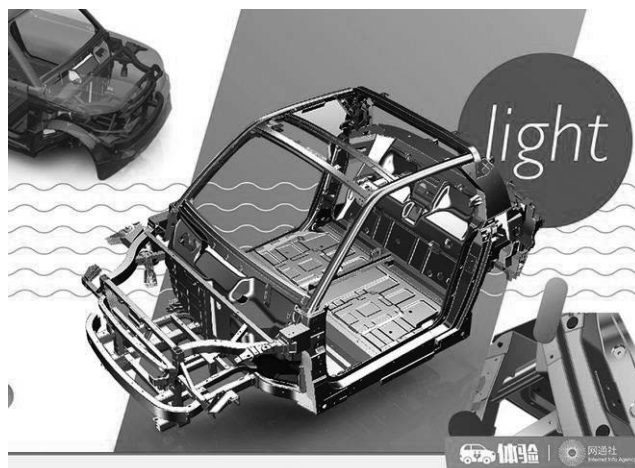
図 42 BAICNewEnergy が独自に開発した超小型電気自動車のライトボディ
