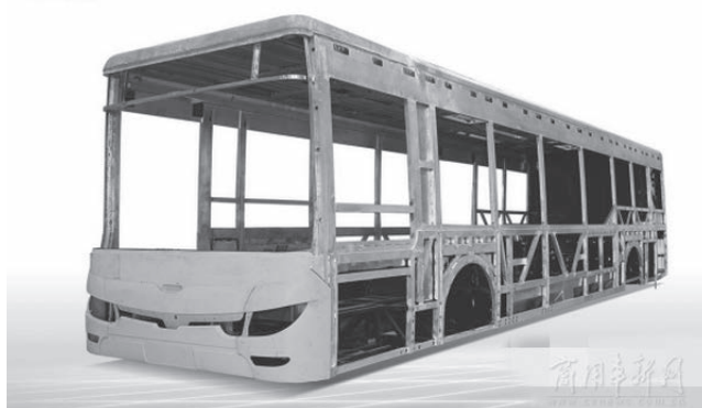
図 13 黄海と遼寧忠旺が共同開発した DD6129EV18 全アルミニウム製ボディ
