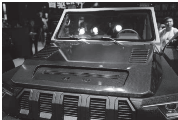
図 18 カーボンファイバーフロントフード付きの BAICBJ80 ジープ
