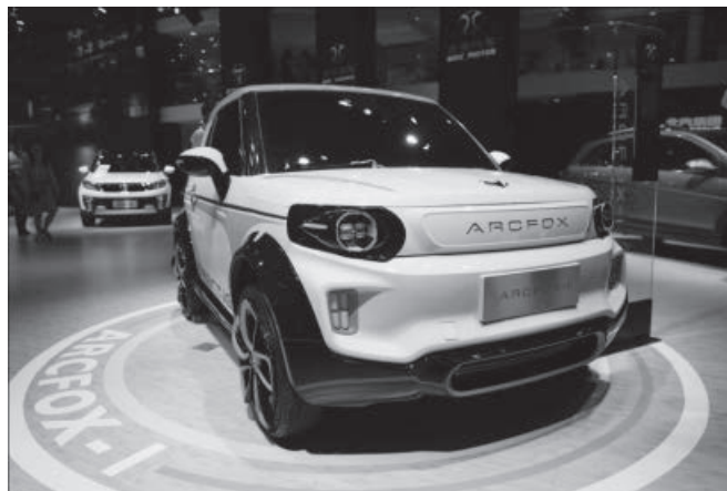
図 17 北汽 NewEnergy の ARCFOX- 1、上半身は康得复材が開発した炭素繊維コンポーネント
