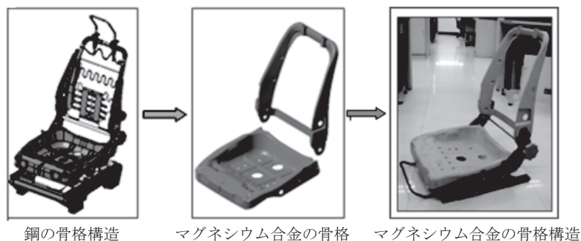
図44 スチールからマグネシウム合金シートフレームへの構造変化
