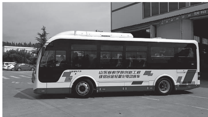
図6 マグネシウム合金製ボディフレームを搭載した電気バスのデモカー
