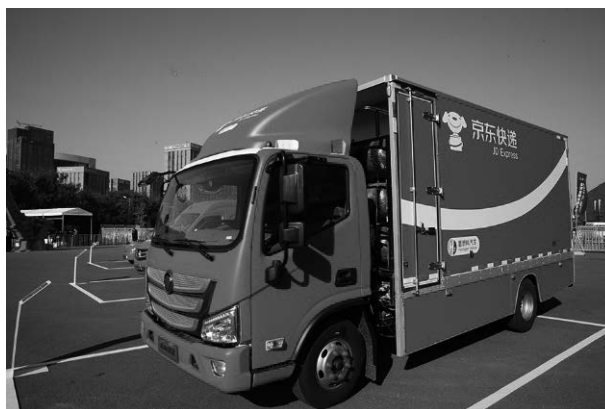
図7 億華通と北汽福田が共同開発した燃料電池物流車両
