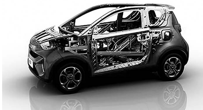
図8 eQ1 のスケルトン構造
