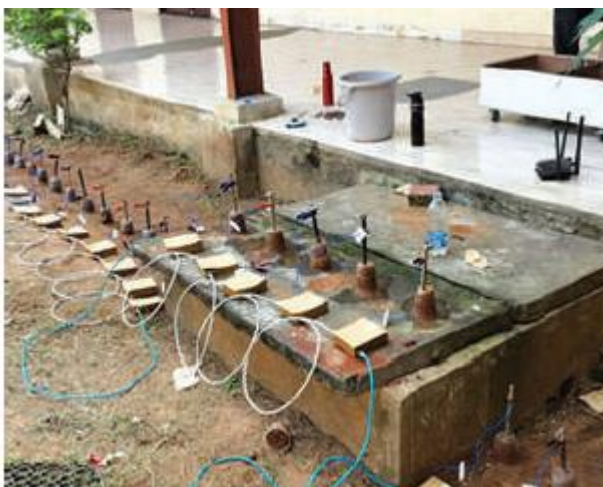
写真：地下の隠れた漏れを感知するセンサーシステム
