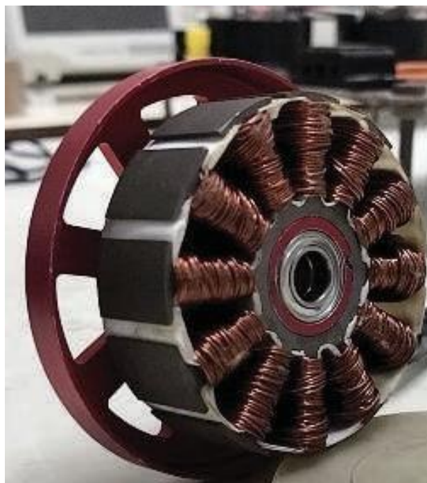
写真：無人航空機用の国産ブラシレス永久磁石モーター
