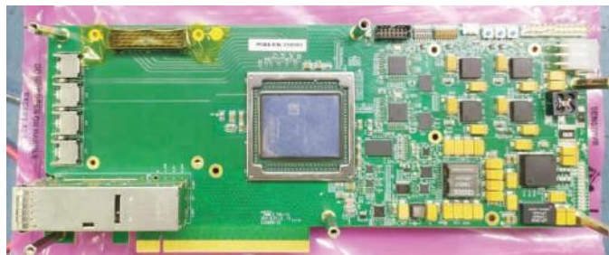
写真：Trinetra相互接続ボード
