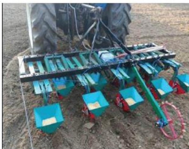
写真：センサーを使用する耕運機用精密播種後付けモジュール
