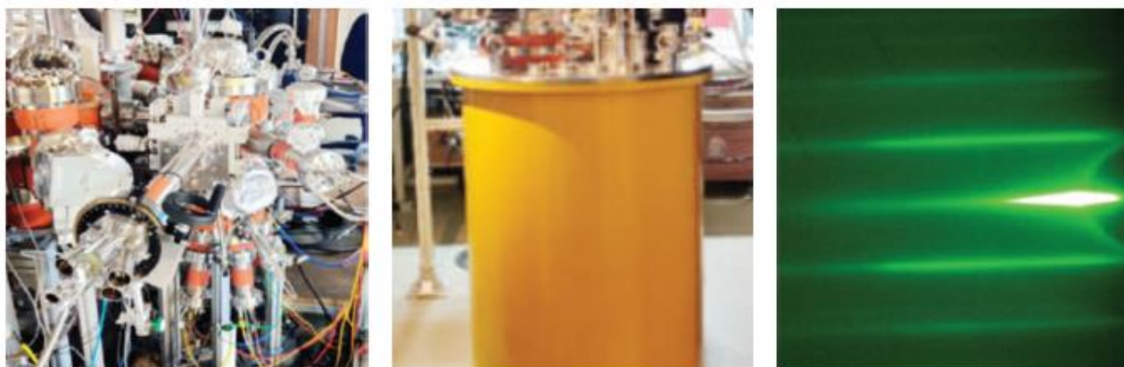
写真：研究所内で組み立てられた分子線エピタキシー、VTIクライオスタット、RHEED出力。
