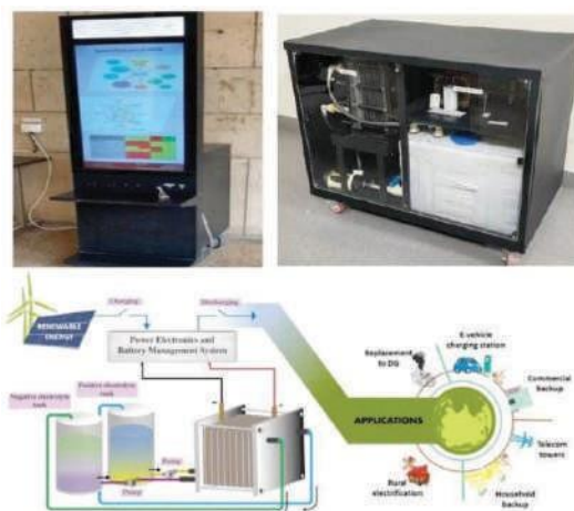
図：大規模再生可能エネルギー貯蔵システムに使われるバナジウムフロー電池
