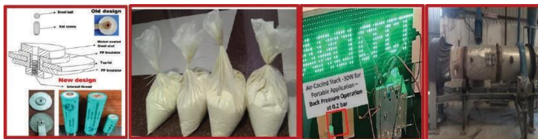
図：リチウムイオン電池用蓋アセンブリ、大規模粉砕LFPカソード材料、空冷式オープンカソードを使用したPEMFC (30 W)、及び結合磁石用回転焼成炉の開発
