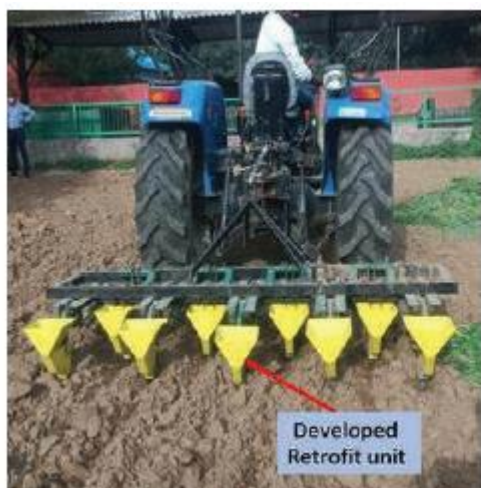
写真：センサーを使用する耕運機用精密播種後付けモジュール
